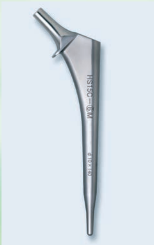
K-MAXステムです。 材質はチタン合金(Ti-15Mo-5Zr-3Al)です。
