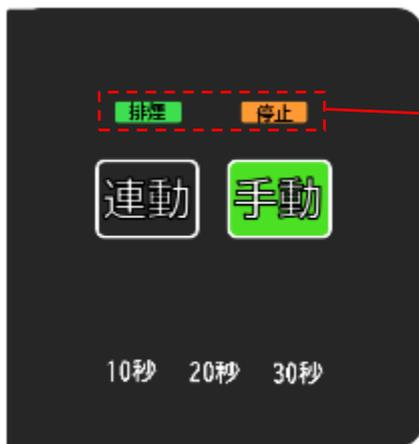
クランプの開閉状態に応じて、排煙 LED / 停止 LED のいずれか1つが点灯します。
