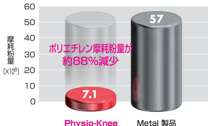
大腿骨コンポーネントにアルミナ・セラミックスを使用した Physio-Knee と、Metal を使用した製品のポリエチレン摩耗粉の関節内総量を比較した結果、Physio-Knee は  $7.1 \times 10^6$  個で Metal 製 ( $57.0 \times 10^6$  個) に比べ有意に少ないことがわかりました。
