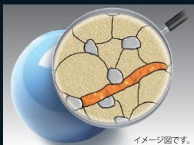
ZTA(ジルコニア強化アルミナ)セラミックアルミナとジルコニアを複合し、両者の優れた強度と表面硬度(耐摩耗性)と安定性を持ち合わせた材料です。
