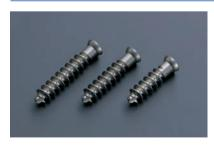
アウターシェル固定用の チタン合金製スクリューです。 ネジ山径は6.5mmでキャン セラスタイプとなっており、 強固な固定が得られます。 セルフタップで使用しますが、 骨質の硬い症例のために、 専用のタップが用意されて います。
